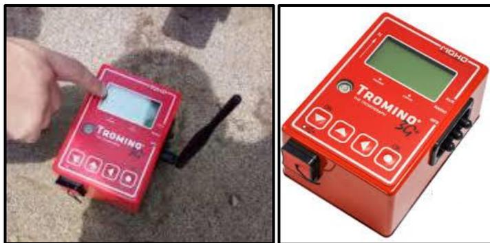
Figura iv.1 Geófono Tromino utilizado para obtener datos analizados en el presente estudio.
