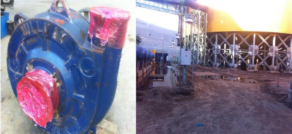
Desde Servicio Técnico de Taller CNN-CAP la bomba FLSmidth Millmax es reparada con sello mecánico recuperado-modificado para poner a prueba, es entregada a la unidad de área húmeda espesadores y es enviada a ser instalada en bomba N°4 espesador N°1.
