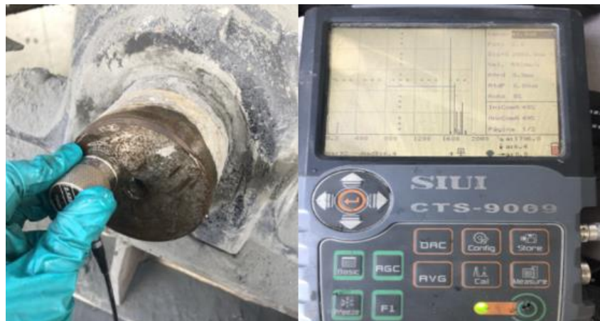
Figura 4.2 Pruebas no destructivas volumétricas [Fuente: Mantenimiento Pucobre]
