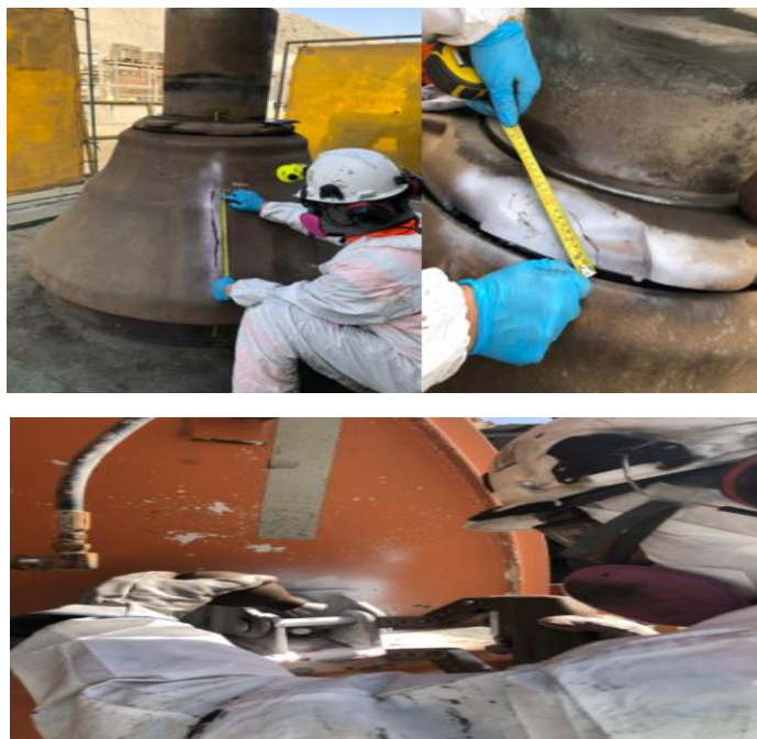
Figura 4.1 Pruebas no destructivas superficiales [Fuente: Mantenimiento Pucobre]
