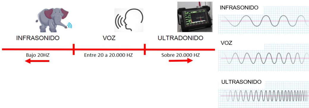
Figura 4.4 Esquema de frecuencias [Fuente: Ensayos ultrasónicos]
