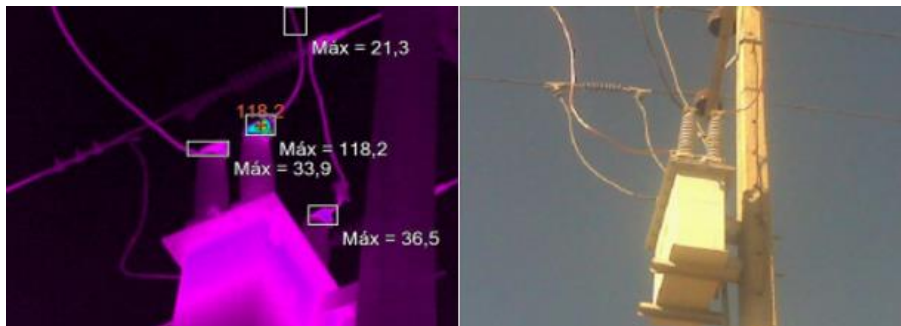
Figura 3.23 Delta de temperatura entre fases [Fuente: Mantenimiento Pucobre]
