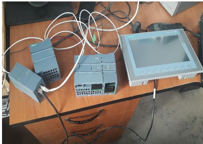
Figura n°21: Modulos del PLC y HMI.
