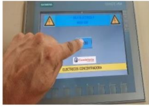
Comunicación entre HMI y PLC. Comando para apertura o cierre de interruptor de media tensión.
