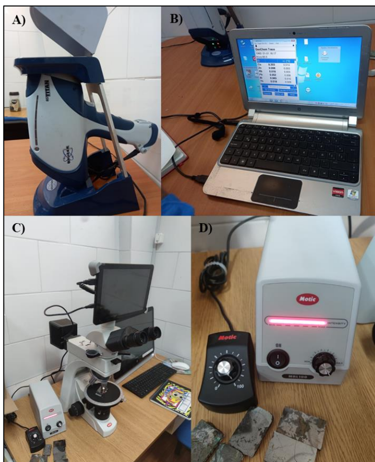
Figura N°3.1: Fotografías de equipo utilizado para análisis geoquímicos y microscopio para observaciones microscópicas. A) Equipo de Fluorescencia de rayos X S1 Titán. B) Software adjunto al equipo. C) Microscopio binocular Motic Ba 310 pol. D) Caja de luz reflejada para análisis de secciones pulidas. (Elaboración propia).
