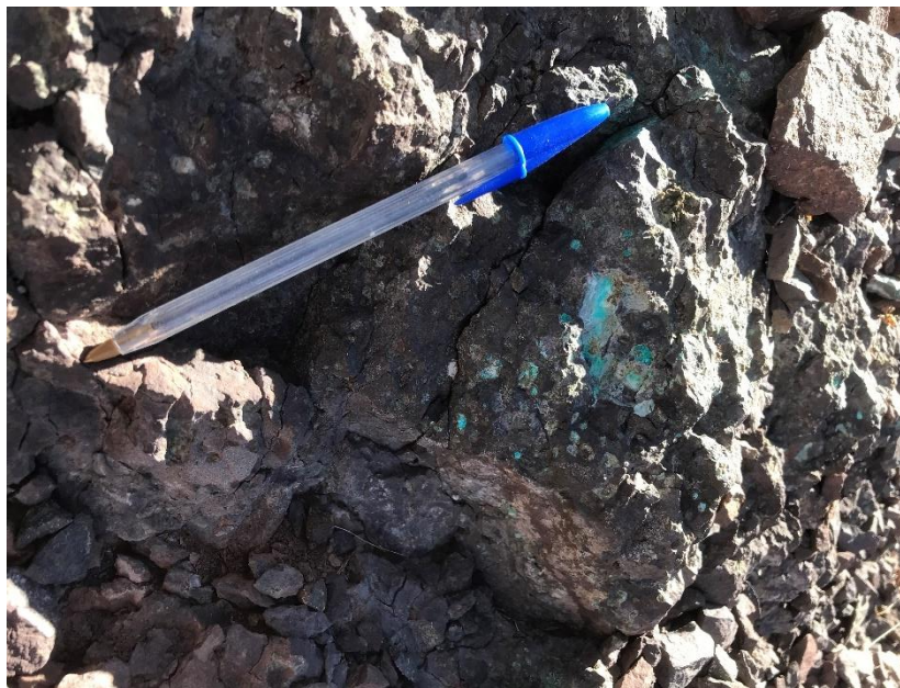
Figura 4.4.3.3 Amígdalas rellenas con crisocola y cuarzo emplazadas en el manto lenticular andesítico el cual atraviesa las propiedades IX y X.
