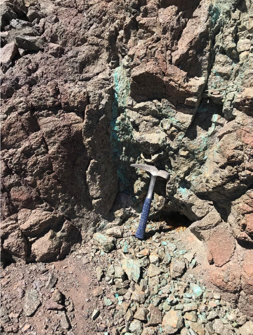
Figura 4.4.4.1 Dique de composición microdiorítica con crisocola y atacamita en sus bordes
