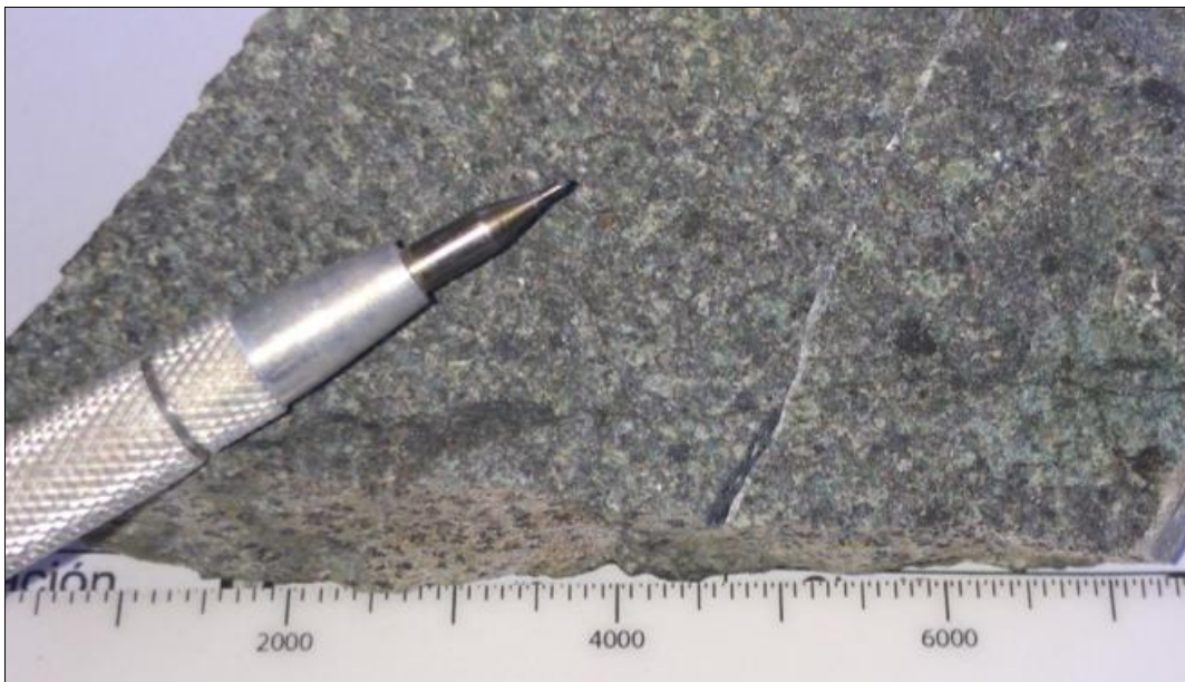
Figura 4.1.4.1 Unidad microdiorítica gris oscuro. Este cuerpo tabular por lo general está asociado a mineralización económica.
