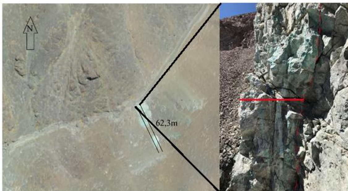
Figura 4.3.1.5. Afloramiento Veta Sur emplazada en las Brechas volcanoclasticas, en la propiedad minera Virgen de Andacollo XVII con mineralización de crisocola, malaquita, atacamita y pátinas de covelina, línea roja indica el espesor de la veta(50cm).
