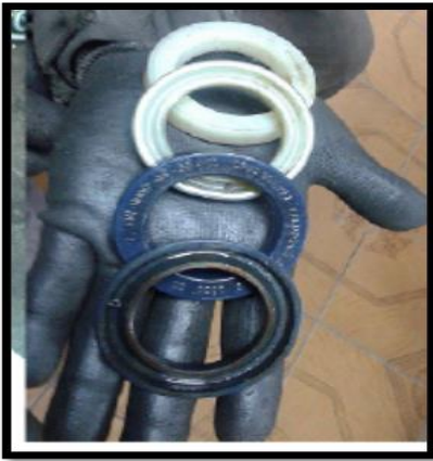
Figura 6.3 Sellos y cámara de barrido desgastados
