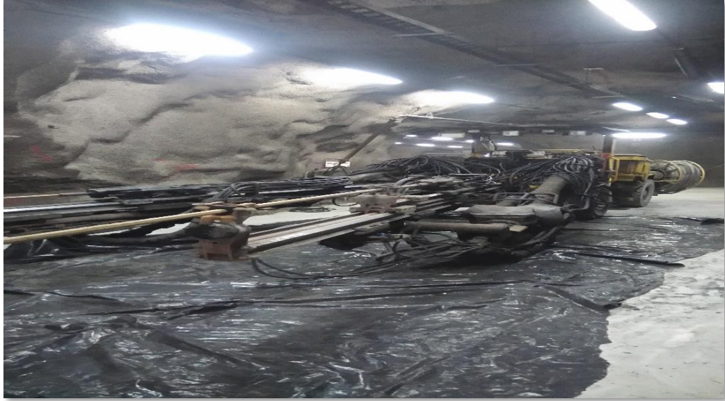
Figura 5.1 Boomer en interior mina.
