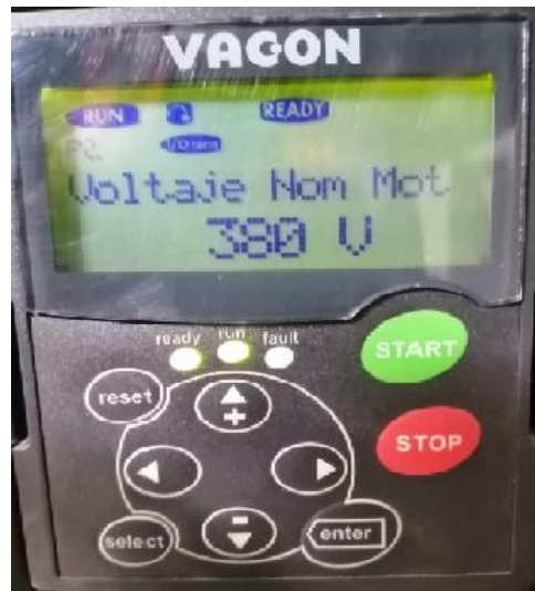
Figura 3.10. Voltaje nominal del motor
