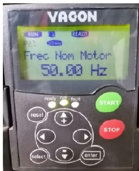
Figura 3.13. Frecuencia nominal del motor.
