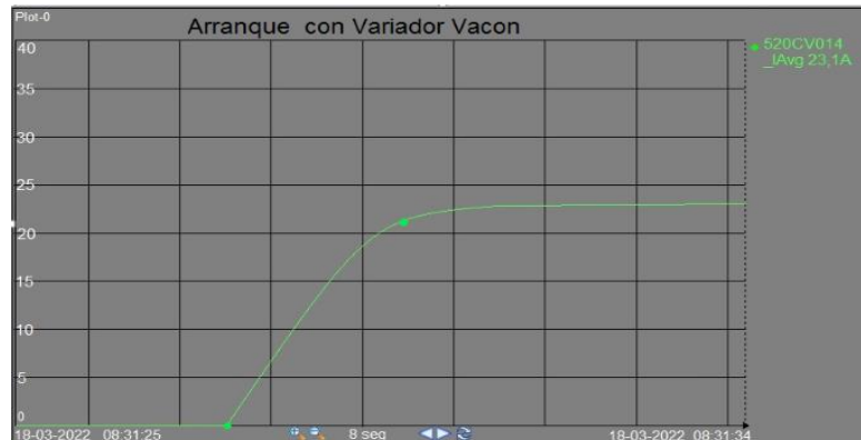
Figura 4.1. Corriente de arranque con VDF.
