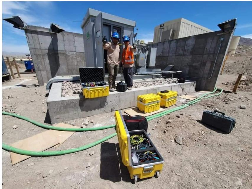
**Figura N° 5.3: Pruebas eléctricas a transformador de poder 23KV/0.4KV 1.5MVA Proyecto RODS Minera Candelaria, Lundin Mining.**
