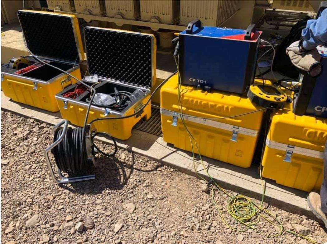
**Figura N° 5.4: Equipos de Pruebas eléctricas Omicron, para pruebas a transformador de poder 23KV/0.4KV 1.5MVA Proyecto RODS Minera Candelaria, Lundin Mining.**
