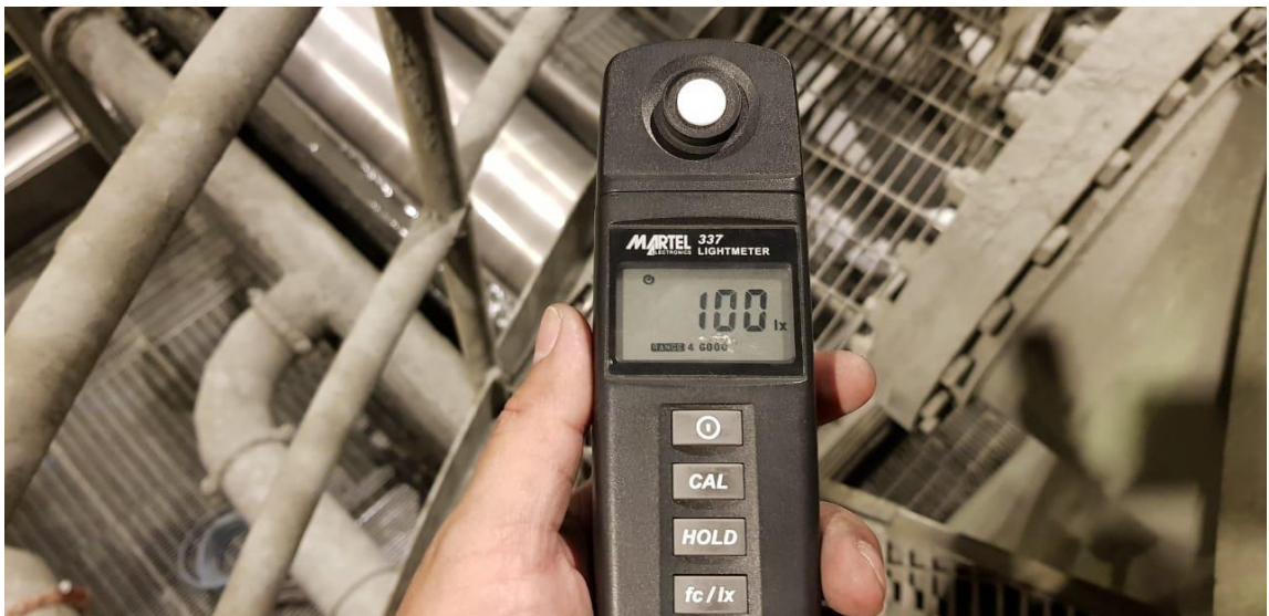
Figura N° 4.30: Medición con el luxómetro en el eje 1.
