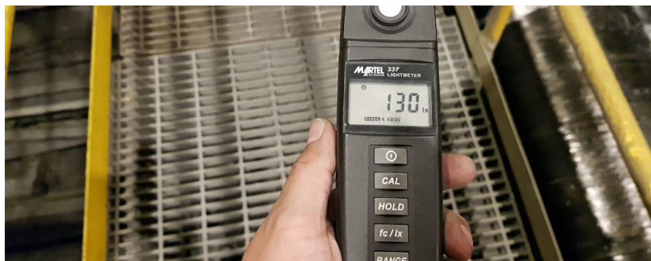
Figura N° 4.31: Medición con el luxómetro en el eje 3.
