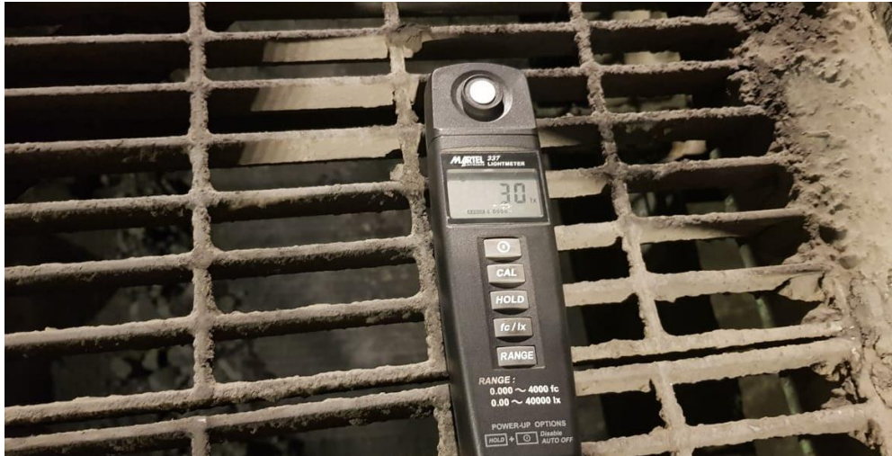
Figura N° 4.17: Medición con luxómetro en el Pasillo 2.
