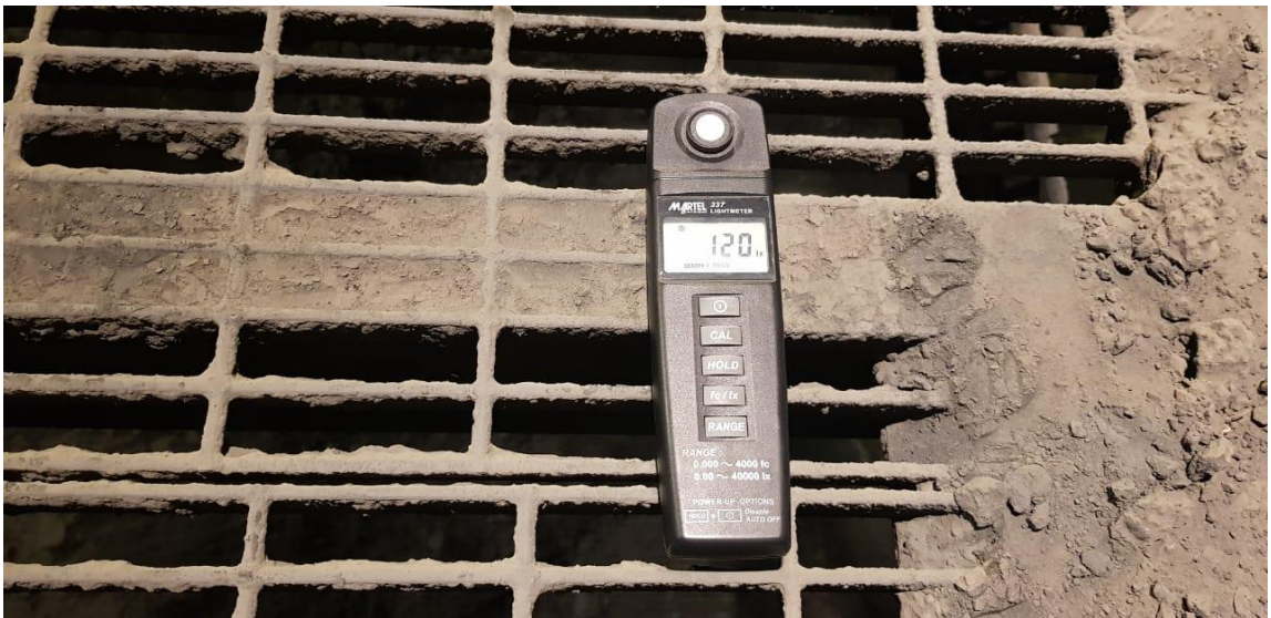
Figura N° 4.16: Medición con luxómetro en el Pasillo 1.
