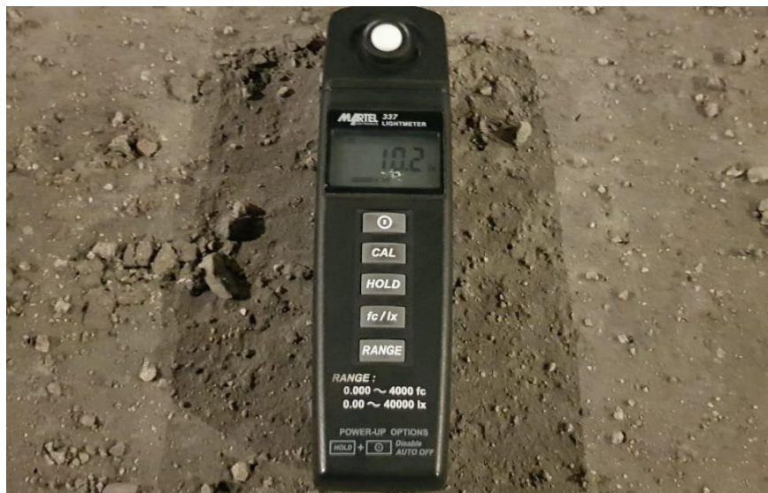
Figura N° 4.44: Medición con el luxómetro entre dos postes.
