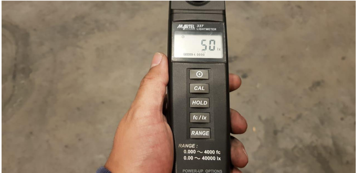
Figura N° 4.29: Medición con el luxómetro en el eje 13.
