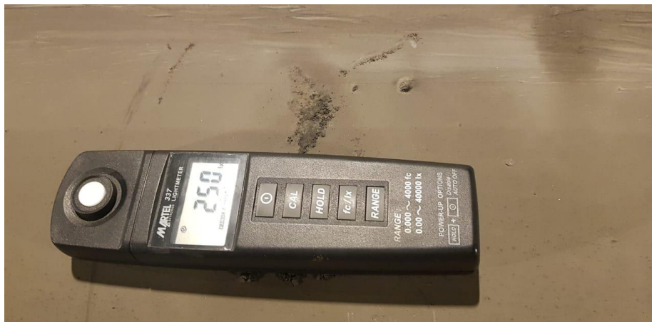
Figura N° 4.18: Medición con luxómetro sobre la Correa Transportadora.
