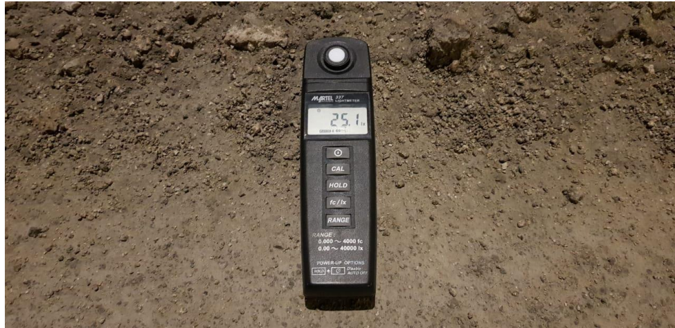
Figura N° 4.43: Medición con el luxómetro de las Luminaria Viales debajo del poste.
