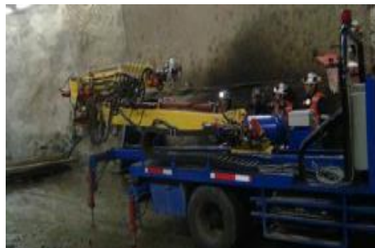
Figura N°4.6. Despliegue del brazo telescópico.
