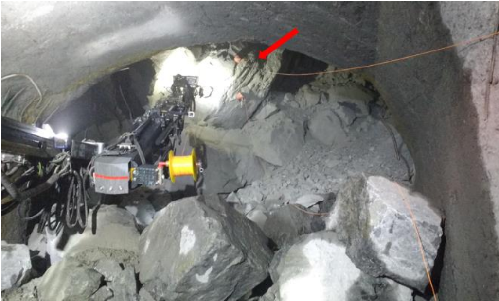
Anexo 8.7. Ubicación conos APD al interior de la zanja a 3 paradas (6 metros aproximado.) (La flecha de color rojo indica ubicación de dos conos explosivos APD)
