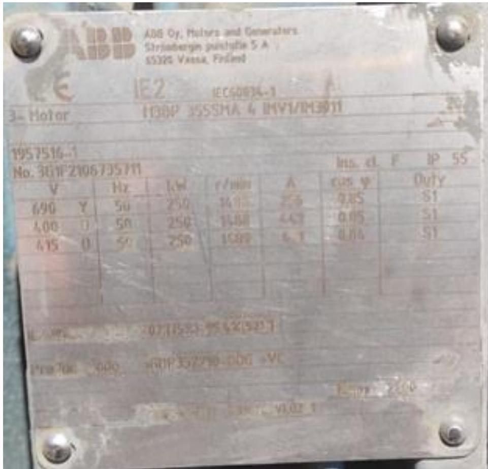
**Tabla N°3.2 Datos Específicos de la placa del motor**
