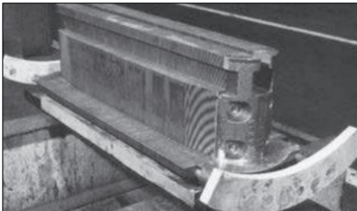
Figura N°2.4. Polo de un generador sin devanados.
