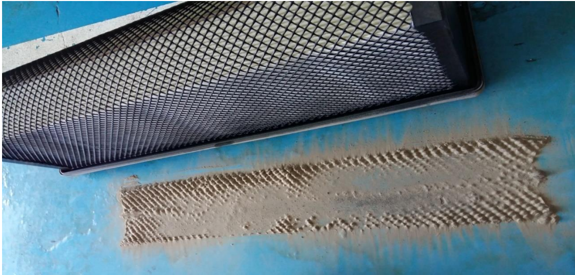
Figura 4.5 Filtro de aire motor saturado en unidad Cascadia 113 de Transportes Verasay.
