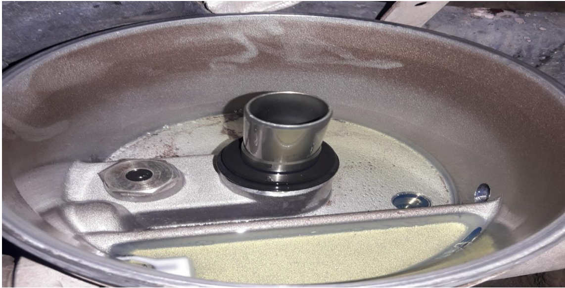
Figura 4.7 Material particulado en base del filtro Racor.
