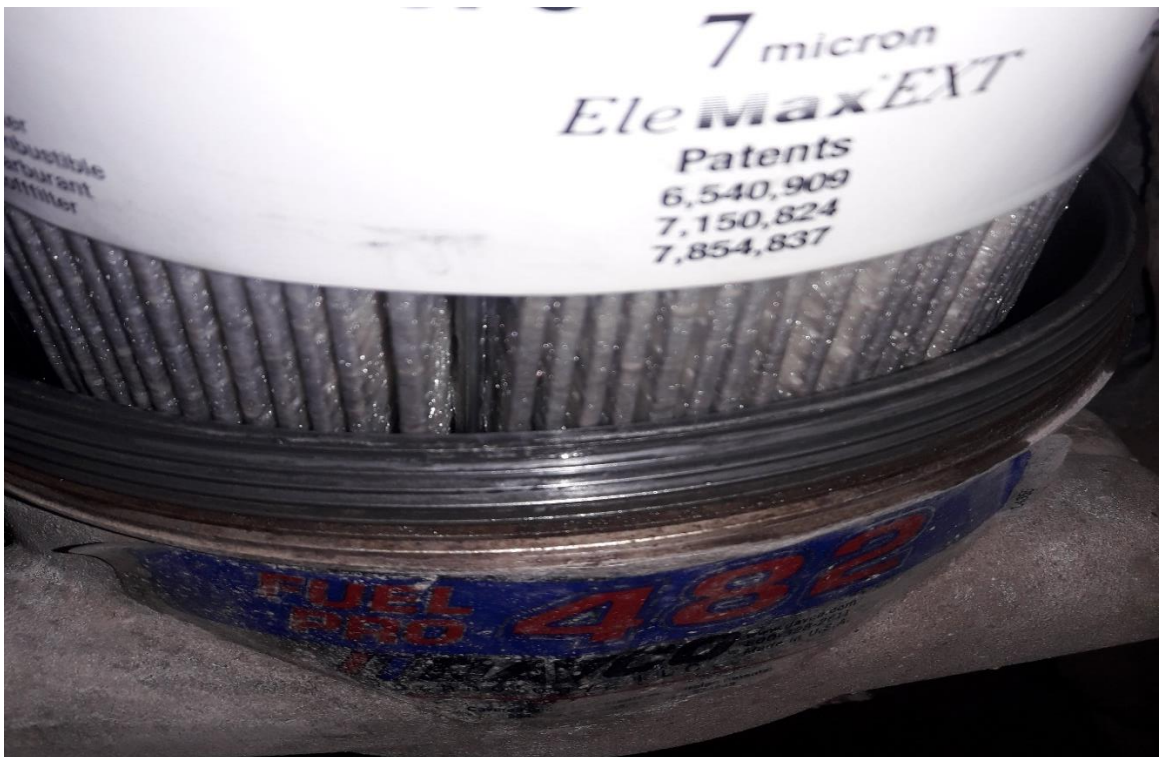
Figura 4.6 Saturación filtro Racor de combustible.
