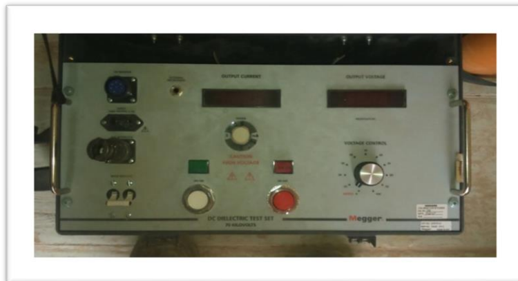
Figura N° 3.13: High Pot módulo de control
