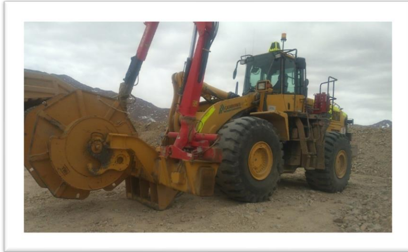
Figura N° 4.2: Equipo enrolla cables
