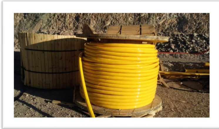
Figura N° 4.1: Cable minero de 8 KV – 400 Amp.
