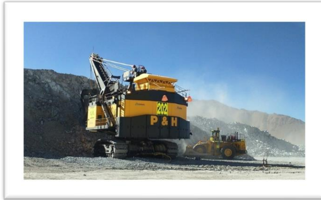
Figura N° 4.6: Traslado de equipos pala P&H 4100
