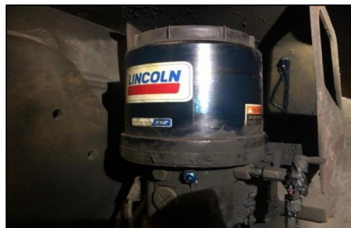
Figura N° 2.35 Sistema de auto lubricación de engrase.
