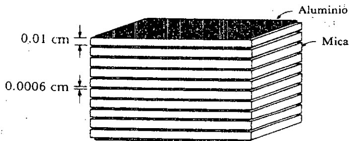
FIG. 13-20 Un capacitor (condensador eléctrico), compuesto de capas alternadas de aluminio y de mica, es un ejemplo de un compuesto laminar.
