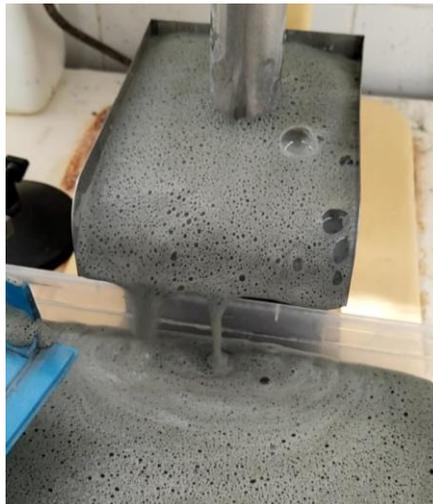
El proceso Cleaner da inicio al pasar 6 minutos de acondicionamiento de la pulpa, para luego dar paso a la inyección de aire a 5 LPM y 1200 RPM, en un tiempo aproximado de paleteo manual de 6 minutos en los cuales la espuma es nuevamente recolectada en recipientes y separados del concentrado Rougher obtenido.
