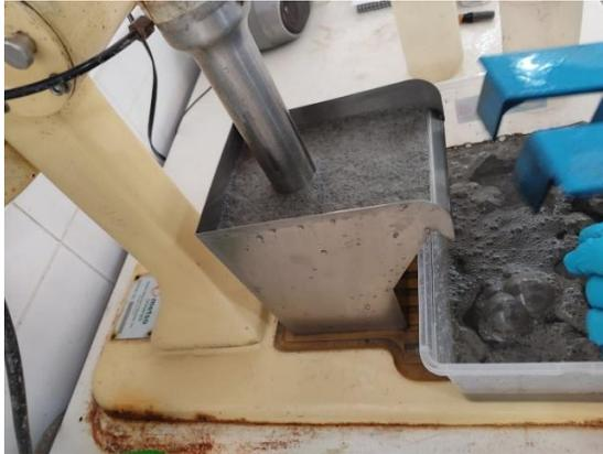
Una vez listo el proceso anterior se pasa a un nuevo proceso de acondicionamiento esta vez para la etapa Scavenger, este consta de 10 min de homogeneización de la pulpa sin inyectar aire, agregando la segunda dosis de espumante al inicio de este proceso. Ya transcurrido el periodo de 10 minutos se abre el paso de aire, comenzando nuevamente el paleteo manual cada 15 min por un transcurso de 10 min, depositando lo recolectado nuevamente en bandejas.
