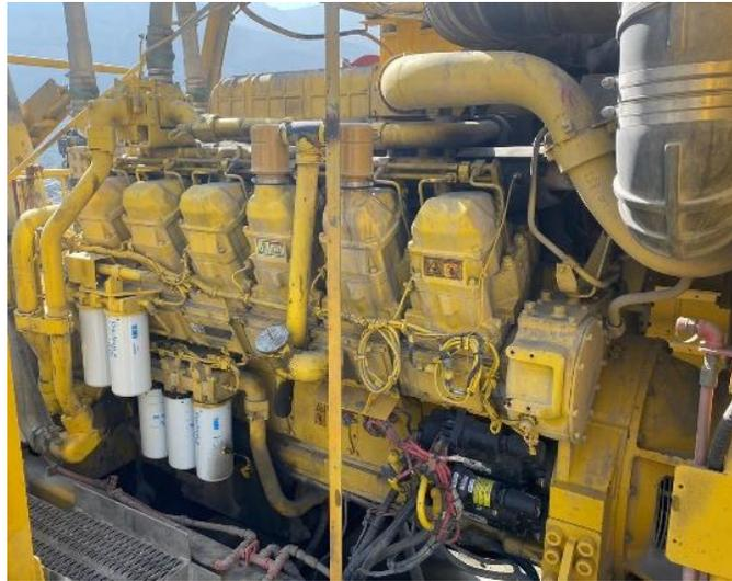
**Figura N° 3.12: Motor diésel Caterpillar 3512.**
