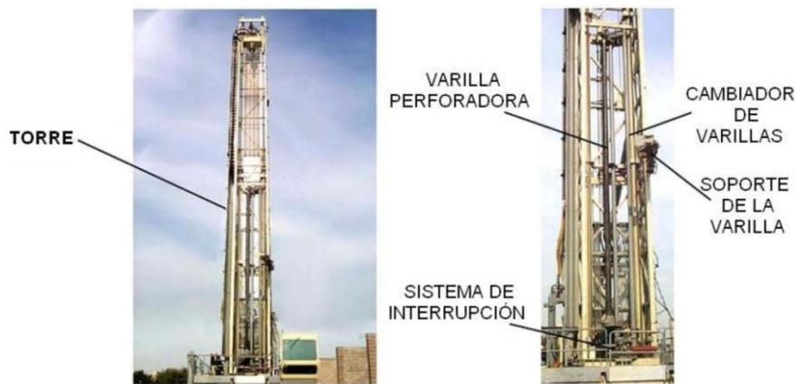
**Figura N° 3.2: Ubicación de componentes principales en torre.**
