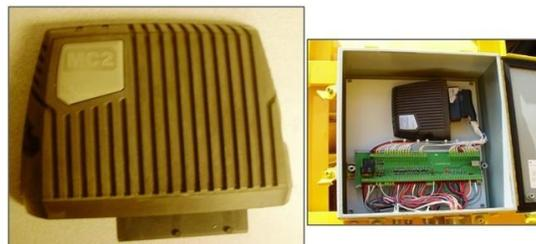
**Figura N° 3.9: Controlador electrónico del compresor de aire (MC2).**
