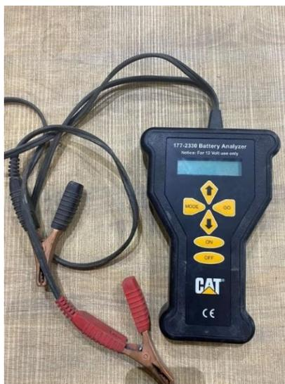
**Figura N° 5.2: Instrumento de revisión de baterías.**
