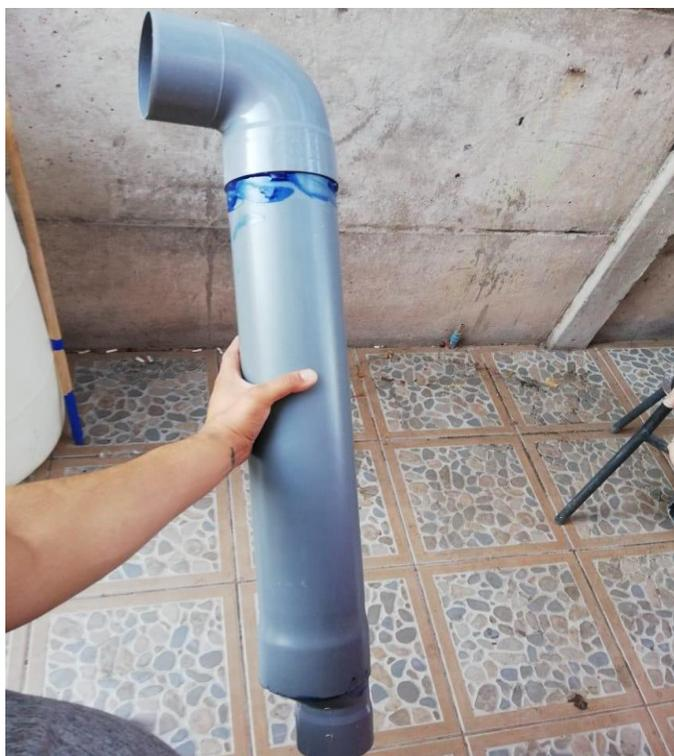
**Figura N° 4.7: Ensamble de tuberías 110 mm para entrada de carga.**
