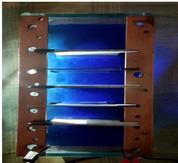
Figura 4.12. Celda de electroobtención, cuarta prueba analítica
