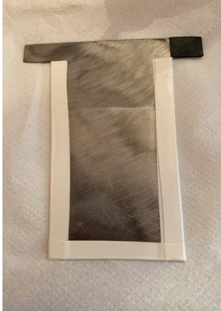
Figura 5.1. cátodo con huincha aislante
