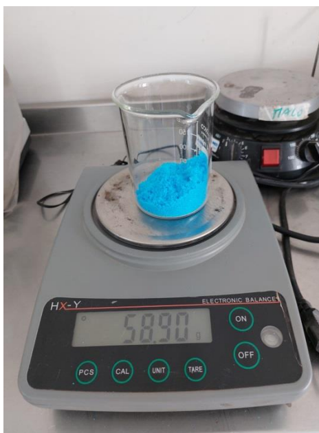
Figura 3.6. Pesaje en balanza semianalítica de sulfato cúprico pentahidratado
