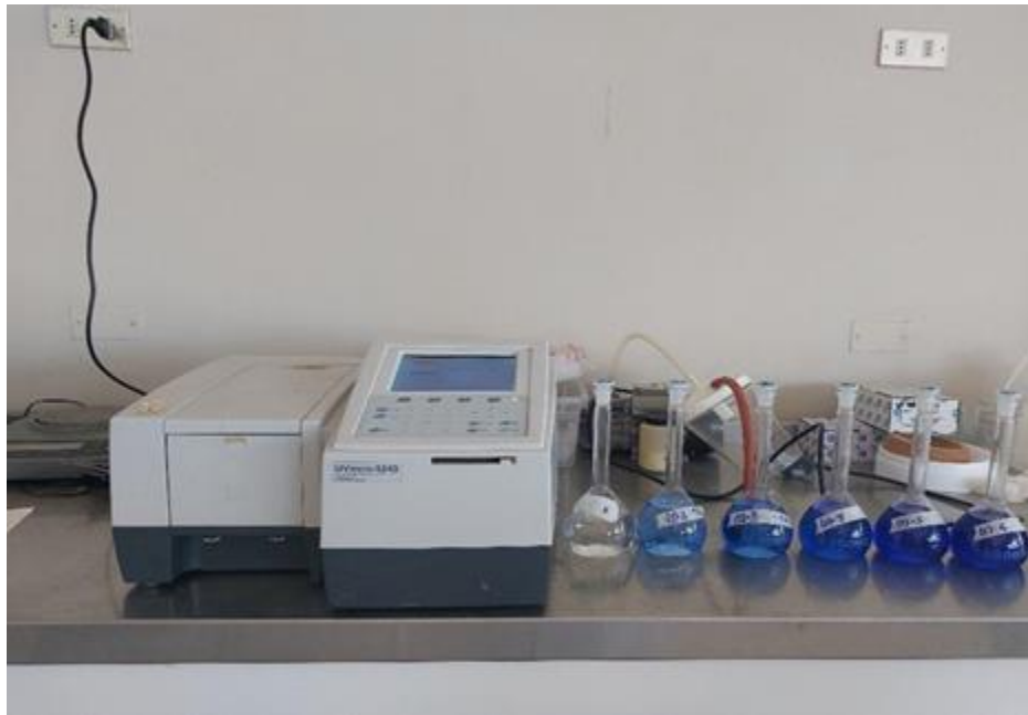
Figura 3.11. Equipo Espectrofotómetro UV-Vis listo para medir la curva.
