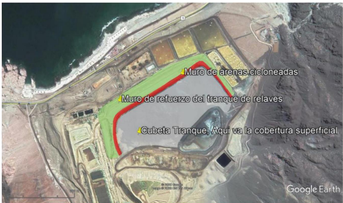
Figura 2.2. Proyecto de contención de tranque de relave.
