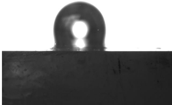
Figura N° 7.69 Burbuja de medición N° 3 para cuarzo transversal a pH 10 y concentración 1 \times 10^{-3} M de hexamina.
