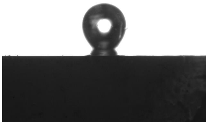
Figura N° 7.58 Burbuja de medición N° 1 para cuarzo transversal a pH 4 y concentración 1 \times 10^{-3} M de hexamina.
