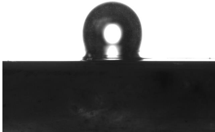
Figura N° 7.50 Burbuja de medición N° 2 para cuarzo basal a pH 10 y concentración 5 \times 10^{-4} M de hexamina.
