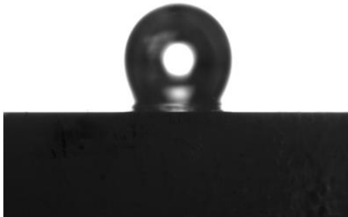
Figura N° 7.79 Burbuja de medición N° 1 para cuarzo transversal a pH 8 y concentración 1 \times 10^{-4} M de hexamina.
