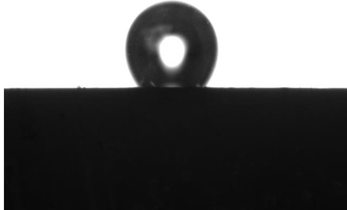
Figura N° 7.5 Burbuja de medición N° 2 para ortoclasa a pH 4 y concentración 1 \times 10^{-3} M de hexamina.
