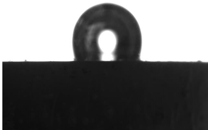
Figura N° 7.21 Burbuja de medición N° 3 para ortoclasa a pH 8 y concentración 5 \times 10^{-4} M de hexamina.
