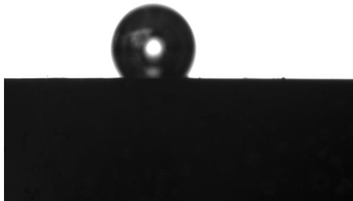
Figura N° 7.18 Burbuja de medición N° 3 para ortoclasa a pH 6 y concentración 5 \times 10^{-4} M de hexamina.
