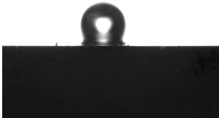
Figura N° 7.80 Burbuja de medición N° 2 para cuarzo transversal a pH 8 y concentración 1 \times 10^{-4} M de hexamina.
