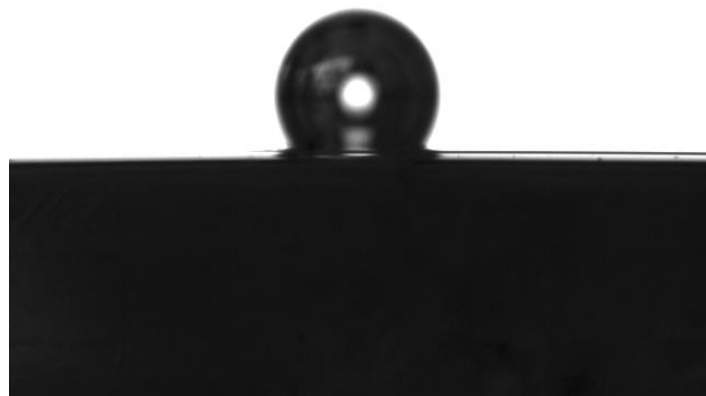
Figura N° 7.46 Burbuja de medición N° 1 para cuarzo basal a pH 8 y concentración 5 \times 10^{-4} M de hexamina.
