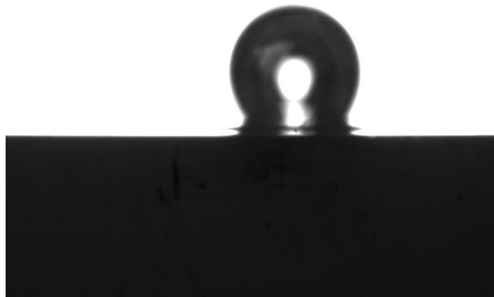
Figura 7.61 Burbuja de medición N°1 para cuarzo transversal a pH 6 y concentración 1 \times 10^{-3} M de hexamina.
