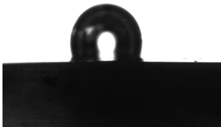
Figura N° 7.57 Burbuja de medición N° 3 para cuarzo basal a pH 10 y concentración 1 \times 10^{-4} M de hexamina.
