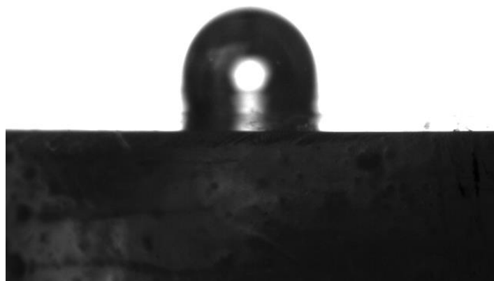
Figura N° 7.84 Burbuja de medición N° 3 para cuarzo transversal a pH 10 y concentración 1 \times 10^{-4} M de hexamina.
