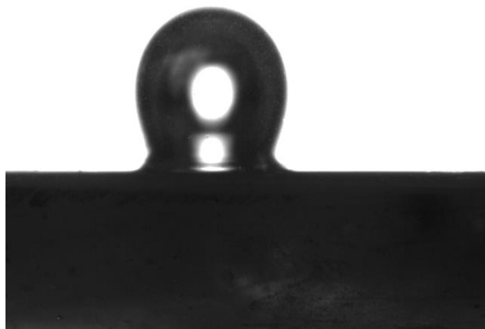
Figura N° 7.51 Burbuja de medición N° 3 para cuarzo basal a pH 10 y concentración 5 \times 10^{-4} M de hexamina.
