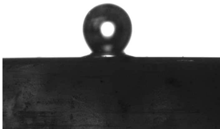
Figura N° 7.38 Burbuja de medición N° 2 para cuarzo basal a pH 6 y concentración 1 \times 10^{-3} M de hexamina.
