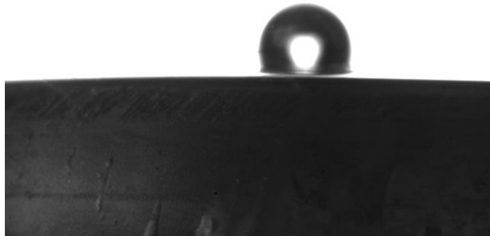
Figura N° 7.45 Burbuja de medición N° 3 para cuarzo basal a pH 10 y concentración 1 \times 10^{-3} M de hexamina.
