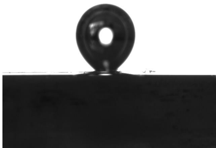
Figura N° 7.36 Burbuja de medición N° 3 para cuarzo basal a pH 4 y concentración 1 \times 10^{-3} M de hexamina.
