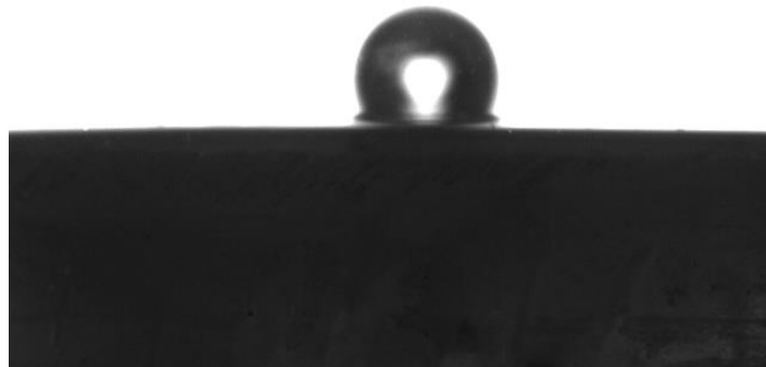
Figura N° 7.42 Burbuja de medición N° 3 para cuarzo basal a pH 8 y concentración 1 \times 10^{-3} M de hexamina.
