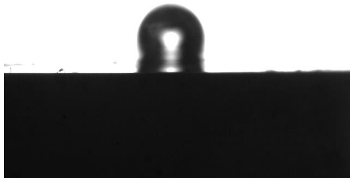
Figura N° 7.83 Burbuja de medición N° 2 para cuarzo transversal a pH 10 y concentración 1 \times 10^{-4} M de hexamina.
