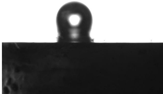
Figura N° 7.82 Burbuja de medición N° 1 para cuarzo transversal a pH 10 y concentración 1 \times 10^{-4} M de hexamina.
