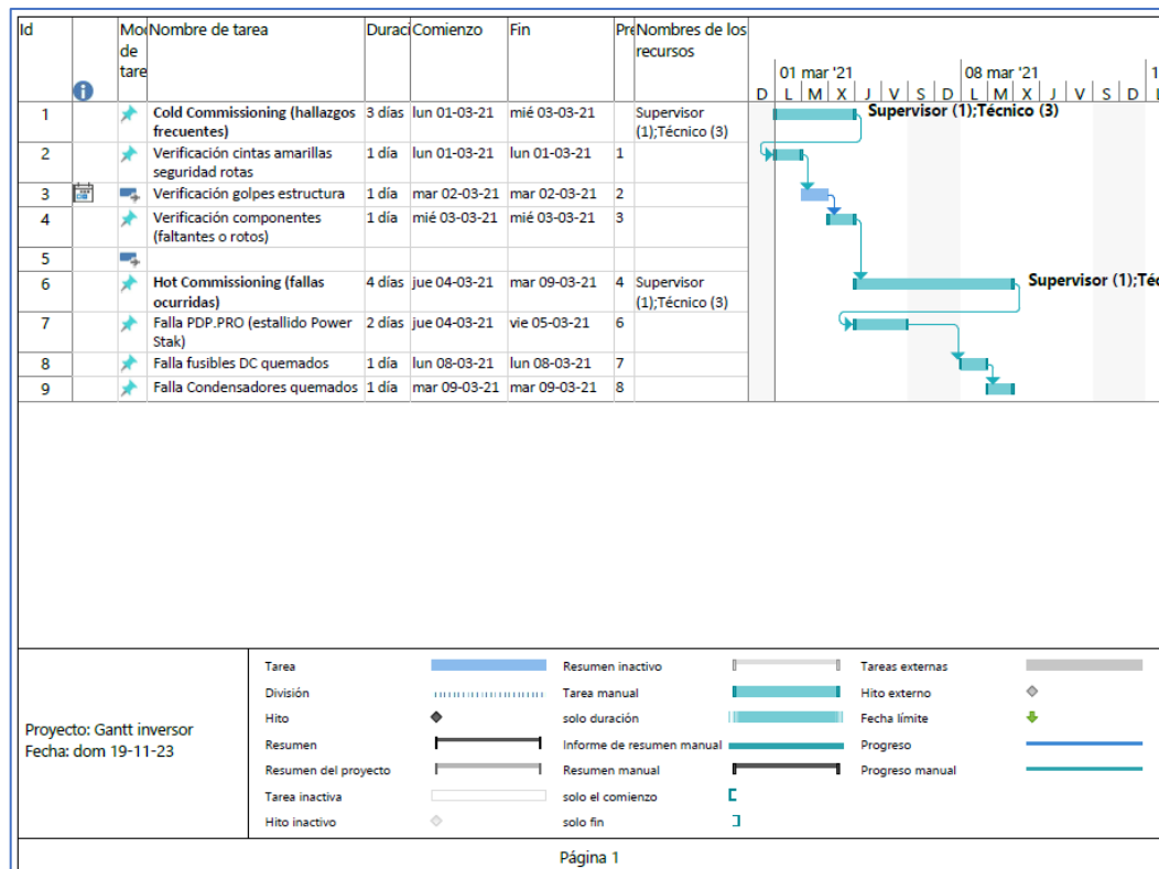
Figura 5.27: Gantt integración un inversor en C.C. & H.C.
