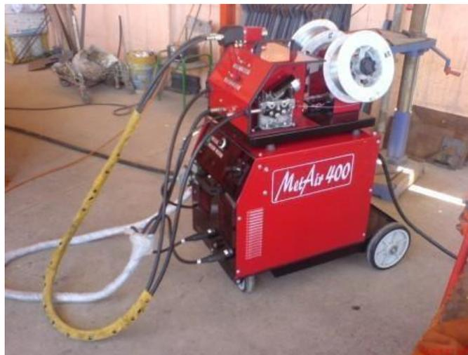
Ilustración 5-2 Máquina ArcSpray MetAir400.
