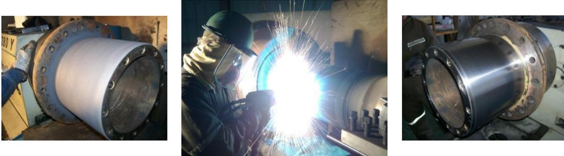
Ilustración 5-3. Soporte Trunion de Cargador Frontal CATERPILLAR 994F, en proceso de reparación mediante rociado térmico ArcSpray. Se pueden ver el antes y el después de metalizado y rectificado a medidas nominales de fábrica, según manual de partes.
