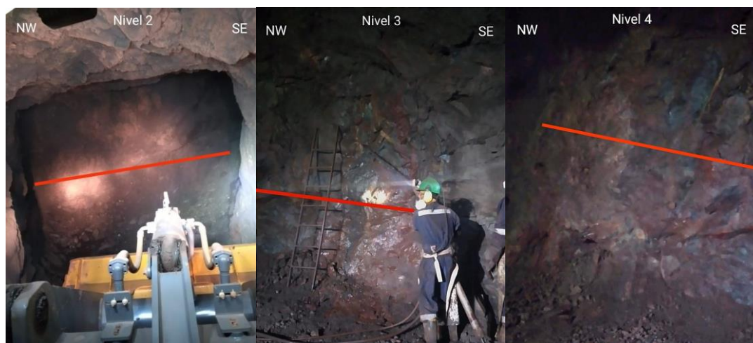
Figura 9: Imágenes de los frentes de explotación de los niveles 2, 3 y 4 señalando en rojo la zona de muestreo.
