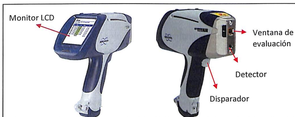
Figura 3.9: Partes del analizador portátil XRF S1 TITAN.
