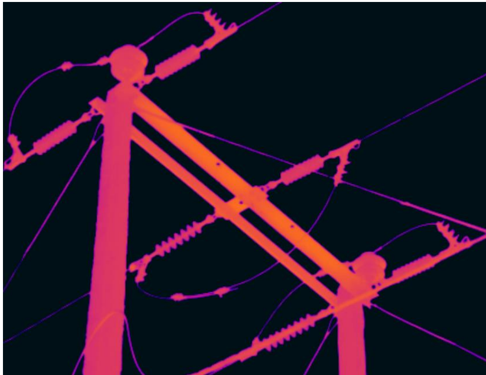
Figura N° 2. 13 Imagen térmica prensas paralela
