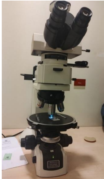
Figura 13: Microscopio polarizador Nikon Eclipse LV100 POL utilizado para el análisis mineralógico y petrográfico.
