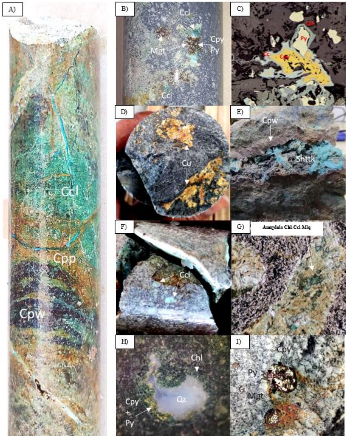
Figura 38: A) veta de crisocola, copper wad y copper pitch en testigo HQ. B) Testigo HQ con crisocola, calcopirita, pirita y magnetita diseminada. C) Corte pulido de calcopirita diseminada, reemplazada por calcosina en asociación con cristales de pirita afectada por limonitización. D) Fractura con Cu nativo. E) Fractura rellena por copper wad y
