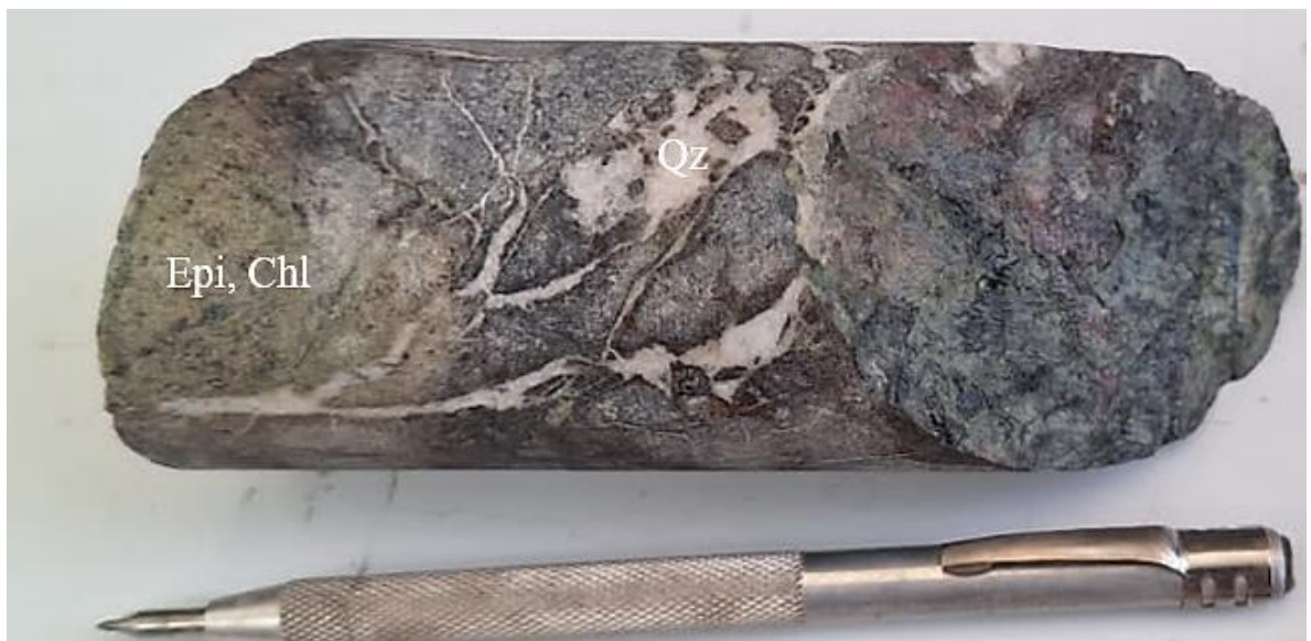
Figura 26: Testigo DDH correspondiente a lavas andesíticas con alteración propilítica cortada por vetillas de cuarzo, evidenciando la relación temporal entre ambos eventos.
