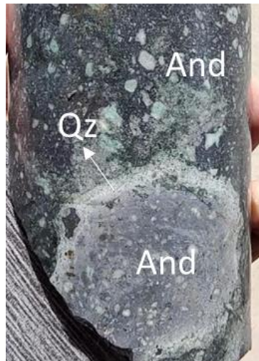
Figura 17: Auto brecha de composición andesítica en testigo, con alteración silícea en borde de clasto.
