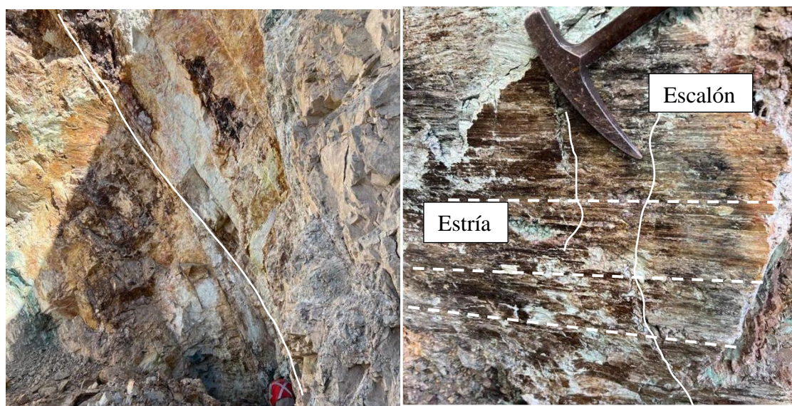
Figura 35: Vista a estructura principal (izquierda) y plano de falla estriado con escalones (derecha), indicando cinemática sinistral.
