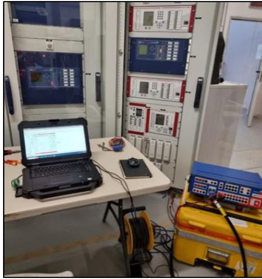
Figura 6.7 Pruebas de corriente en lado secundario con Ómicron CMC356.
