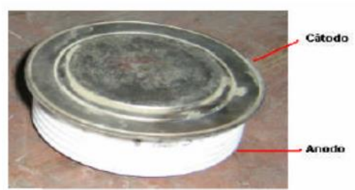
Figura N° 3.11: Diodo de potencia tipo press-pack (ficha de hockey), rectificador principal.
