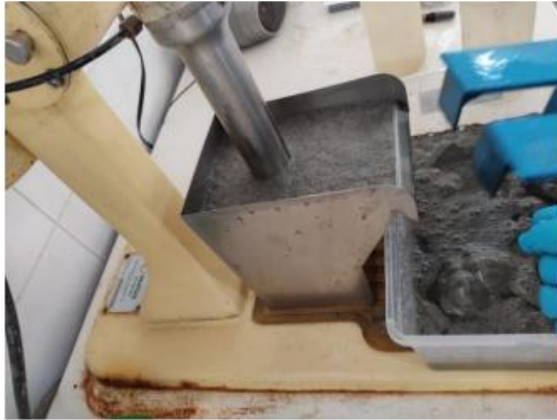
Figura 3.3: flotación de pirita.
