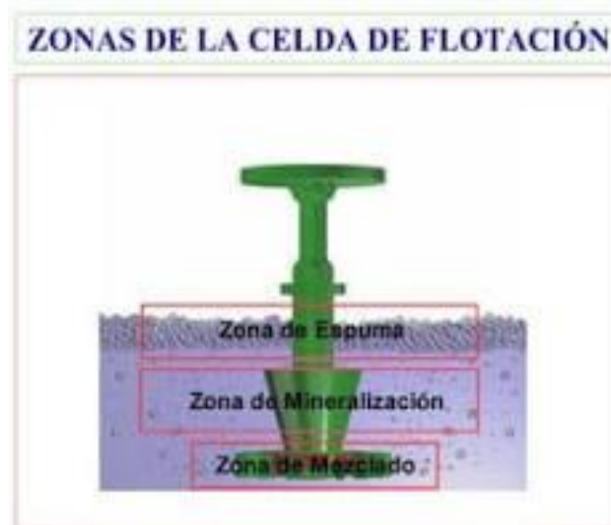
Figura 2.10: Celda de flotación Mecánica.
