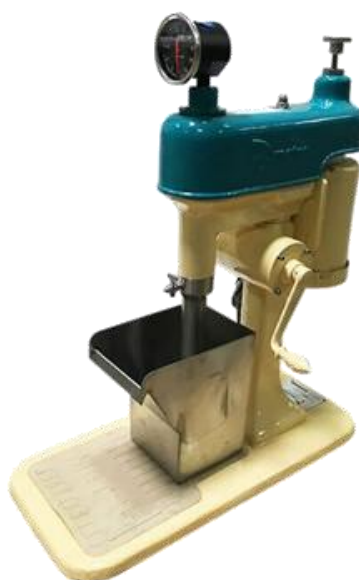
Figura 3.4. Celda de flotación Denver Metso D-12.
