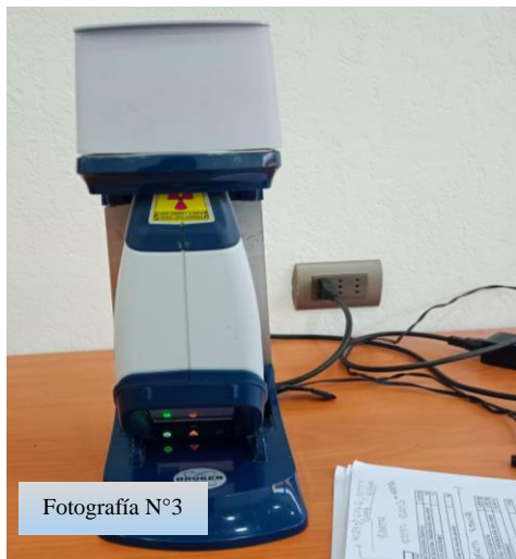
Fotografía N°3 y N°4: Las fotografías muestran la pistola de análisis XRF marca BRUKER ELEMENTAL modelo S1 TITAN vista de frente y de perfil (Elaboración propia).
