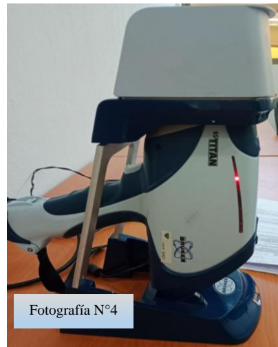
Fotografía N°3 y N°4: Las fotografías muestran la pistola de análisis XRF marca BRUKER ELEMENTAL modelo S1 TITAN vista de frente y de perfil (Elaboración propia).
