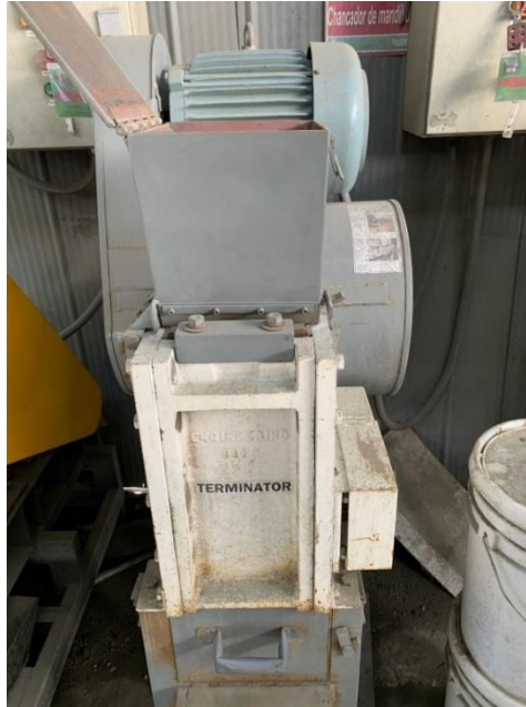
Figura 3.10. Chancador de laboratorio Terminator.
