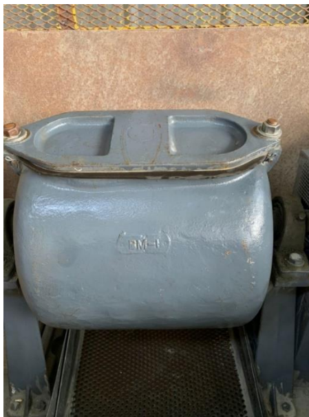
Figura 3.11. Molino de Bond de laboratorio
