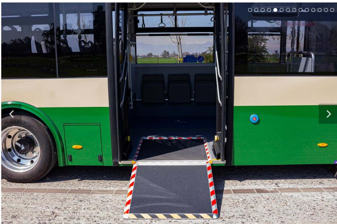
Imagen 51: Rampla ingreso bus
