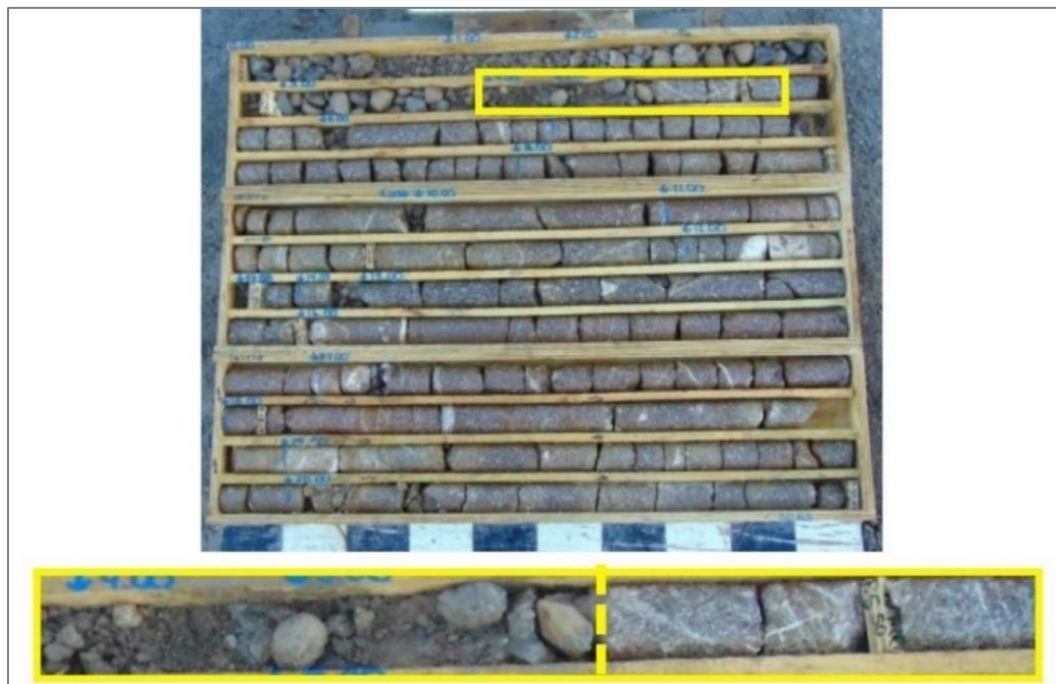
Figura 5.1. Contacto gravas (GRA), con unidad de conglomerados y areniscas (CA). Sondaje: DDH19 – MC – 183.
