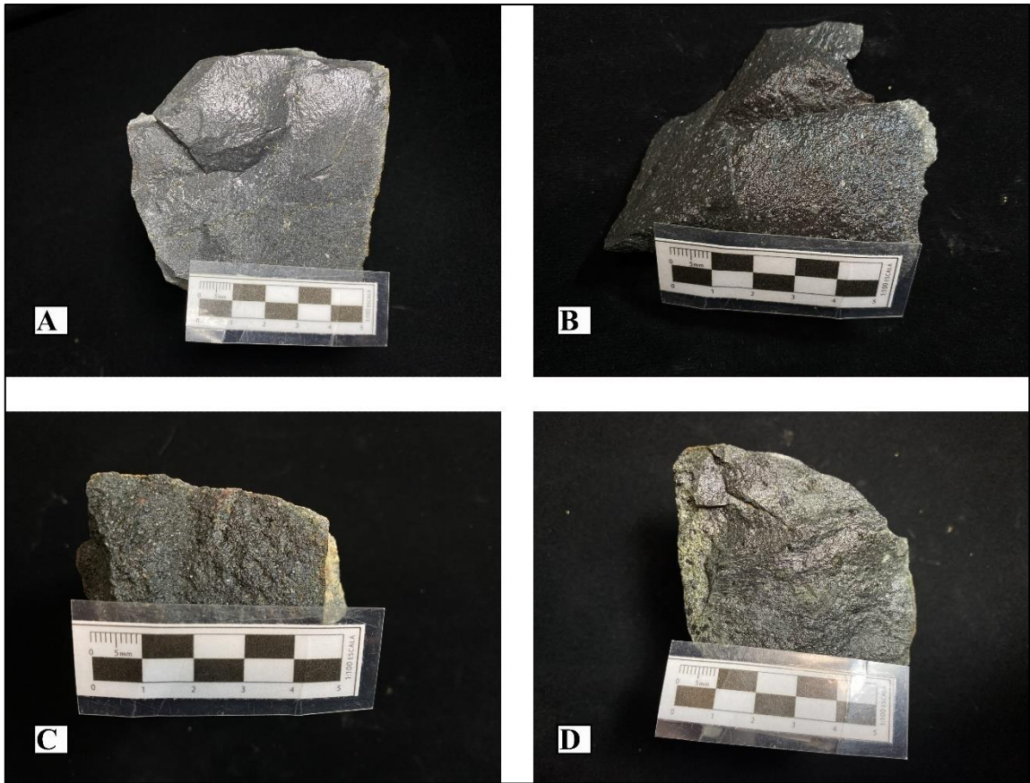
Figura N°4.2 Dique gábrico. (A) Dique gábrico de grano fino. (B) Se observan plagioclasas con poblaciones de tamaño. (C)-(D) Recristalización debido a la intrusión de D2.
