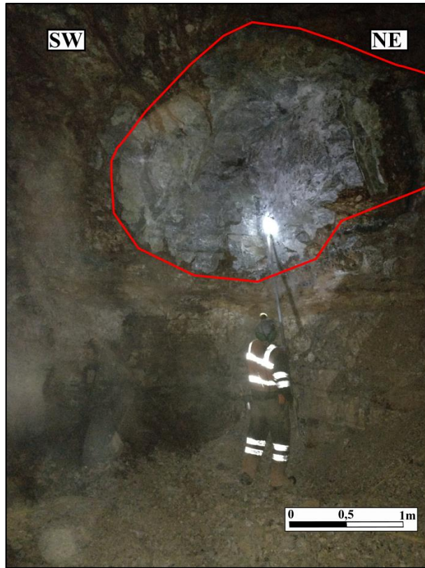
Figura N°4.27 Alteración a sericita en el nivel 1080B.
