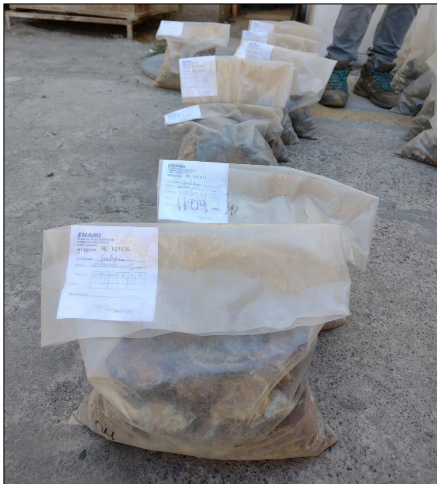
Figura N°3.4 Bolsas con muestras de roca codificadas y selladas para asegurar la cadena de custodia.
