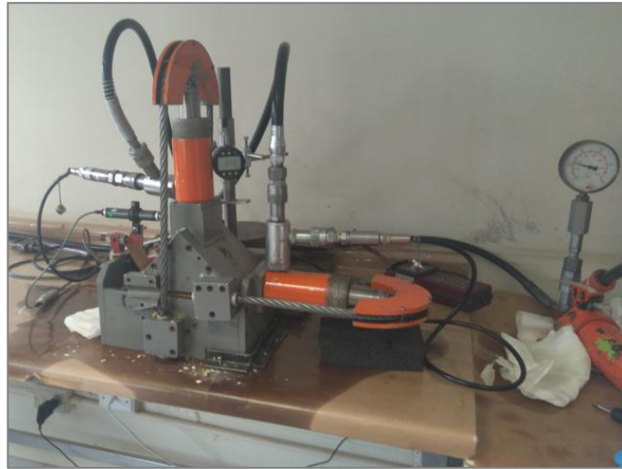
Figura 5.13: Celda hoek para ensayos de corte directo insitu (Elaboración propia).
