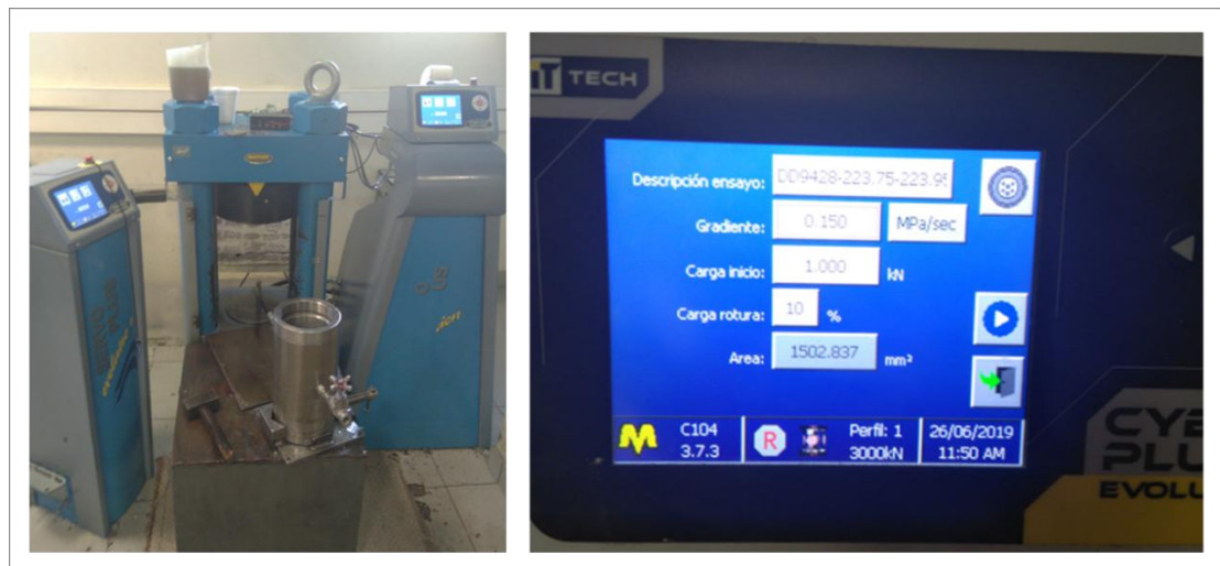
Figura 5.9: Prensa servoasistida marca Matest, con cámara para ensayos triaxiales y monitor que registra los parámetros de entrada para la ejecución.
