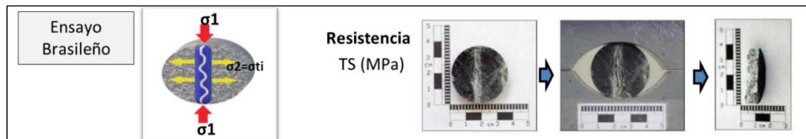
Figura 5.11: Esquemas de los ensayos de tracción indirecta indicando la relación de esfuerzo que participan y los parámetros que se pueden obtener (Elaboración propia).
