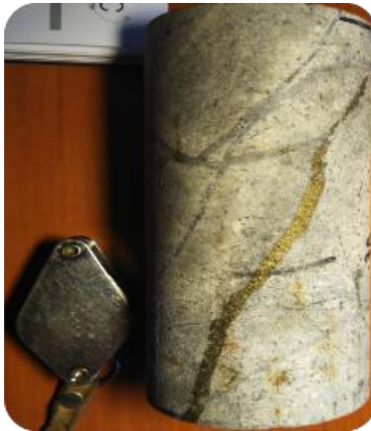
Figura 5.4: Vetilla Hidrotermal Principal (HP) característica de El Teniente con relleno mineral blando de calcopirita mayoritaria, pirita y anhidrita de forma minoritaria, con bordes sinuosos y sutura discontinua.
