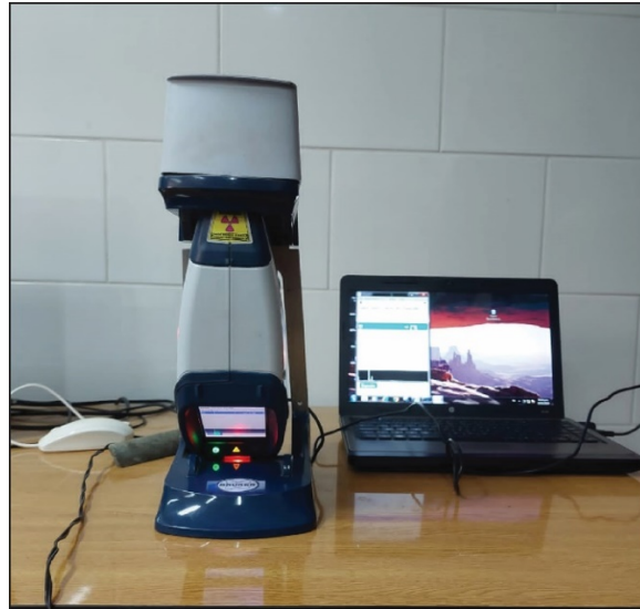
Figura 4.5: pistola XRF portátil BRUKER S1 TITÁN .
