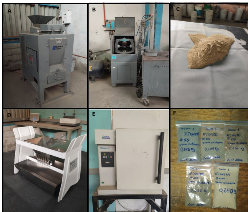
Figura 4.4: en dependencias del Laboratorio de Metalurgia de la Universidad de Atacama, se utilizó la siguiente indumentaria. A) chancador de mandíbulas, B) pulverizador de anillos de acero, C) proceso de roleo, D) cuarteador de riffle, E) tamizador electrónico, F) muestras arrojadas por el tamizado.
