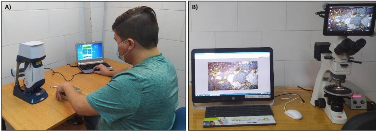
Figura 11. Metodología de trabajo en gabinete. a) Analizador portátil de fluorescencia de rayos X (XRF); b) Microscopio óptico de marca Motic. En dependencias del laboratorio de geología económica, perteneciente al departamento de Geología de la Universidad de Atacama.
