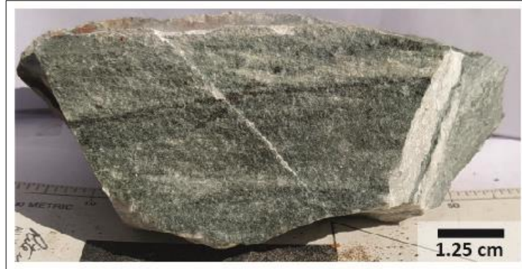
Figura 13. Muestra de mano correspondiente a la muestra 951. Se observa el aspecto general de una roca milonítica, de aspecto aplítico con textura esquistosa. Constituida principalmente por: cuarzo, plagioclasa, feldespatos, y en menor porcentaje muscovita, clorita y epidota.
