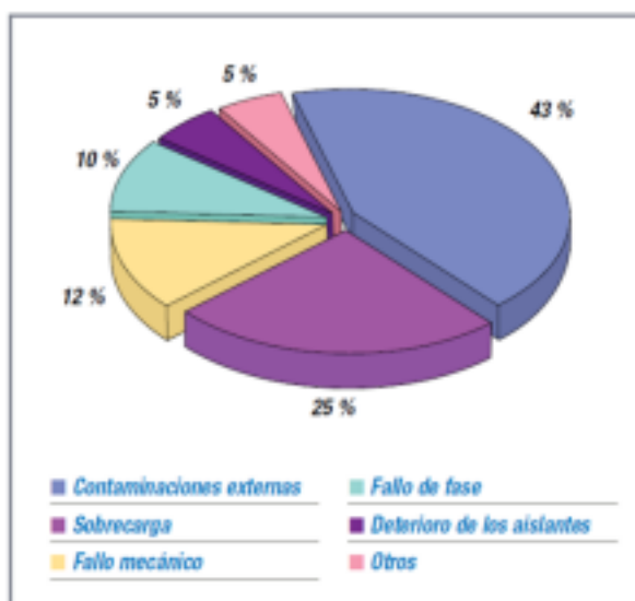
Figura 2.5 Gráfico de distribución de fallas más comunes en un motor
