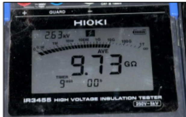
Figura 3.4 Resultado de primera medición aislación motor 008.
