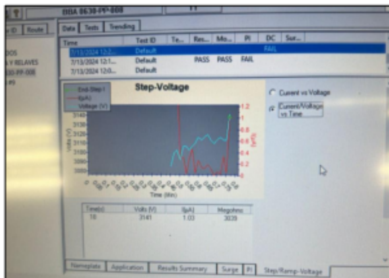
Figura 3.8 Falla de sobre corriente en el motor
