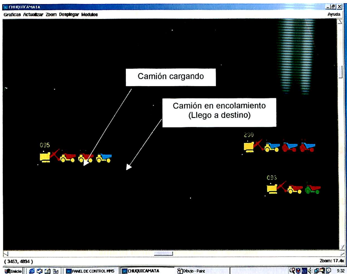
Fig. 4.16 Camión llega a destino y en espera (Imagen de Gráficas de Mina Dispatch)
