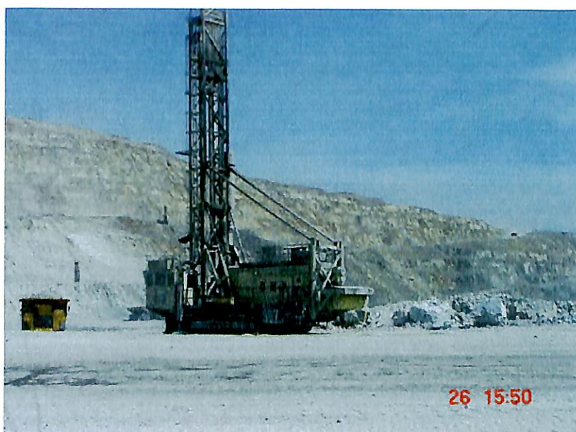
Fig. 2.1 Perforación en Banco
