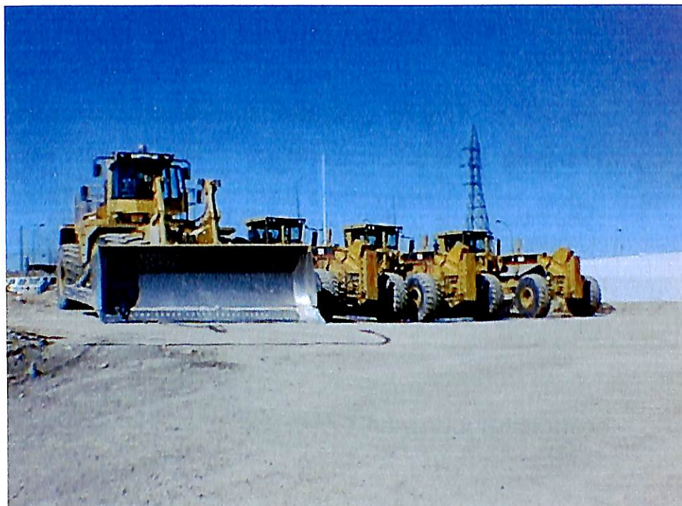
Fig. 2.9 Tractor Neumático y Motoniveladoras de la Unidad Movimiento de tierra
