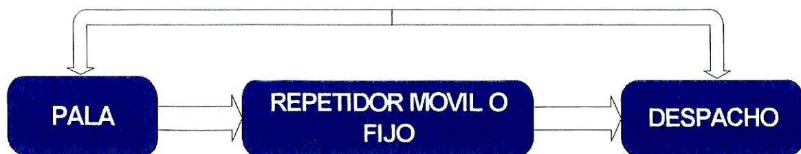
Fig. 6.22 Diagrama Funcionamiento red Inalámbrica en repetidores móviles o fijos
