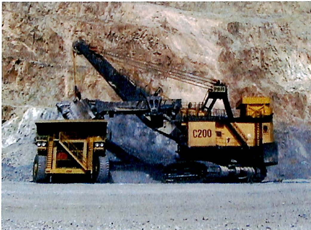
Fig. 4.6 Pala realizando la descarga de material
