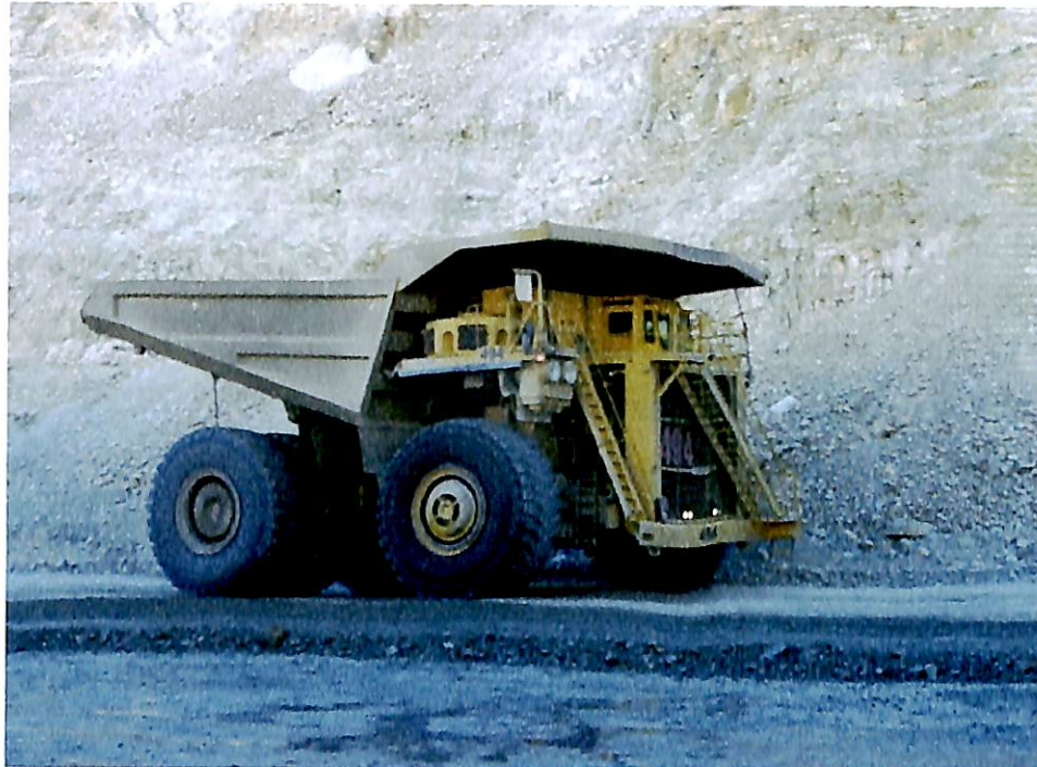
Fig. 2.7 Camión Liebherr modelo T 282
