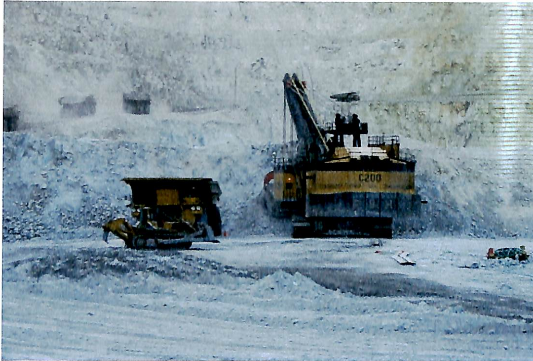
Fig. 4.9 Tractor montado sobre orugas realizando limpieza de cancha en la zona de carguío
