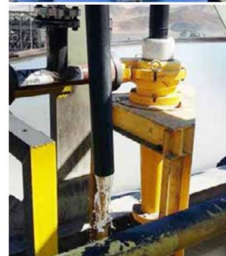
Arriba: Hidrociclones Cavex® DE con ACB™ instalados en una mina en Chile.
