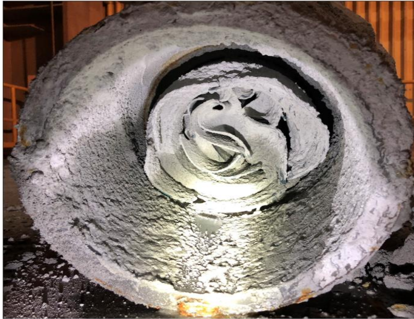
Figura N° 2.18: Obstrucción de apex por carpetas plásticas externas.
