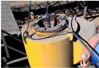
Arriba: Sensor de monitoreo conectado al ACB™ de un hidrociclón Cavex®.
