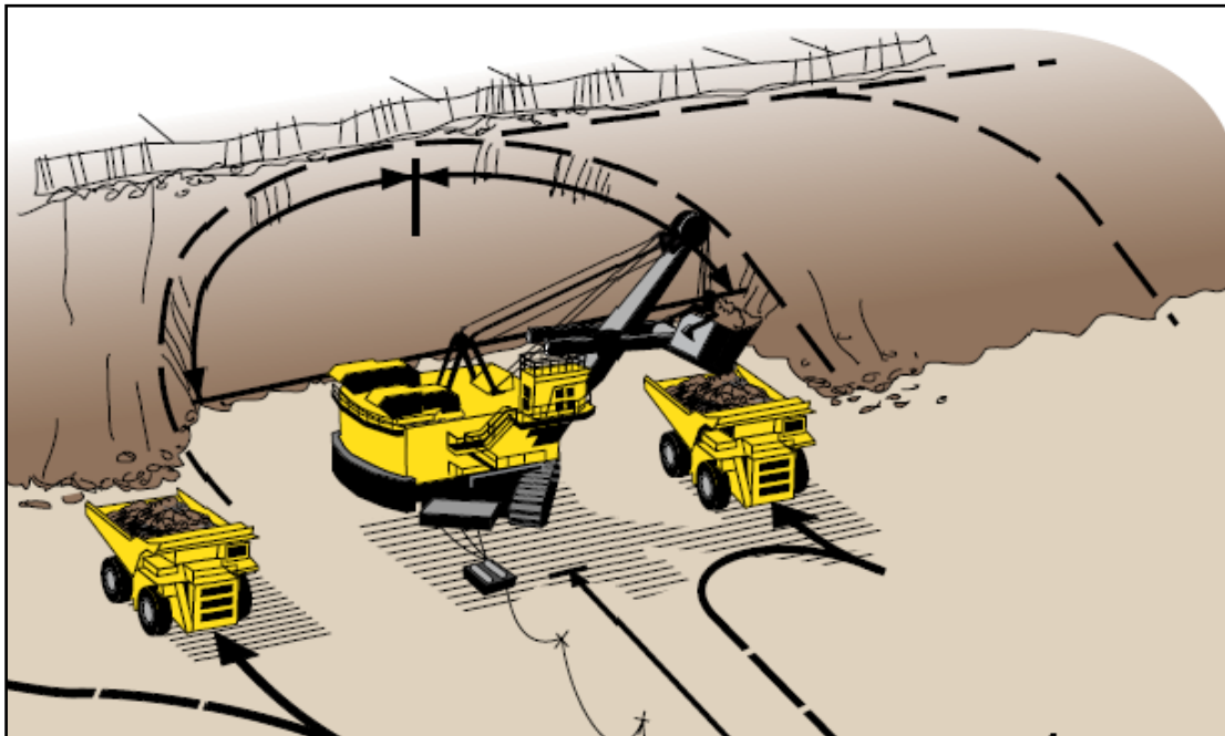
Figura N° 2.1: Movimientos de la pala.
