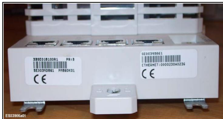
Figura N° 3.7: Etiqueta de la dirección Ethernet.
