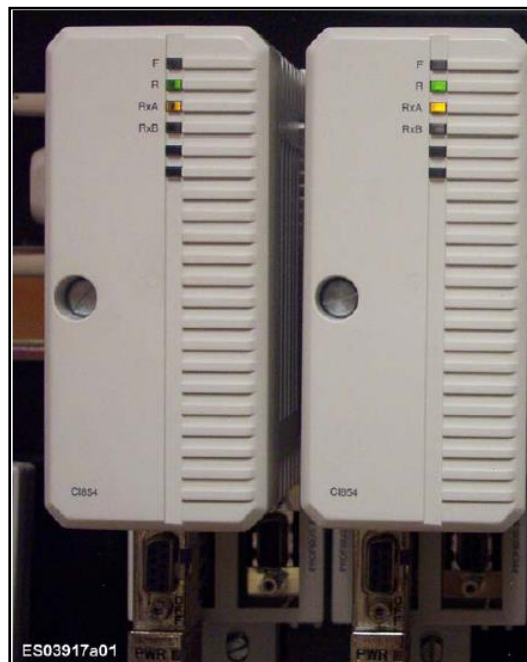
Figura N° 3.9: Módulos de interfaz del profibus DP-V1.
