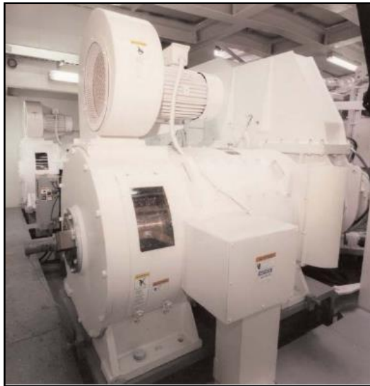
Figura N° 2.20: Motor típico de levante con ventilador centrífugo.
