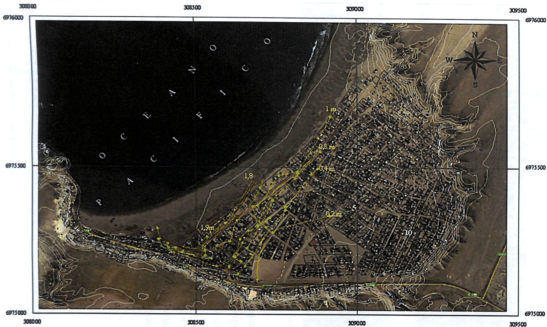
Figura 5.11. Vivienda con altura de inundación máxima registrada de 1,9 m (punto rojo). Isolneas (en verde) de altura de inundación (Fuente: Elaboración propia) (Anexo 13).
