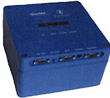
Figura 2.1. Geófono GBV-316 portátil. (Fuente: Servicio Sismológico de Chile).
