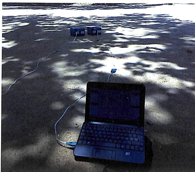
Figura 2.2. Instalación del geófono con orientación norte-sur y conexión al laptop.
