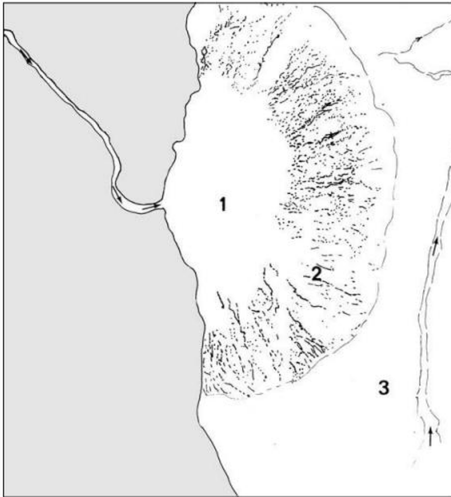
Figura N°3.6 Esquema planimétrico idealizado de un abanico aluvial aislado con la distribución de los principales sectores diferenciados: 1) Cabecera (zona apical) del abanico. 2) Cuerpo del abanico. 3) Pie del abanico. Modificado de Arche, (2010).
