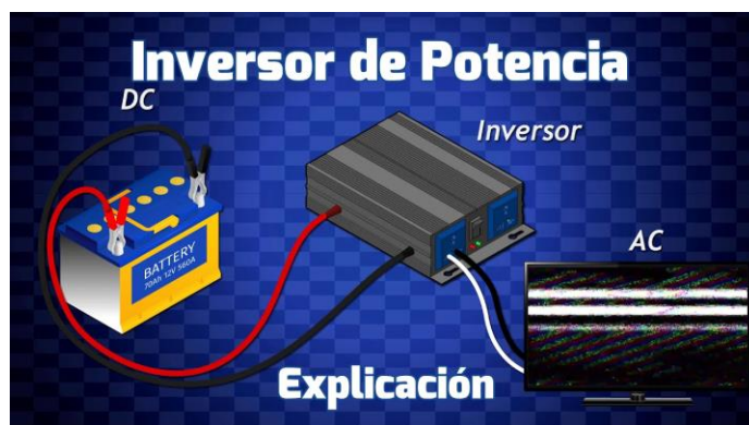
Figura Nª 1.15: Diagrama de inversor que transforma la corriente continua (DC) en corriente alterna(AC)
