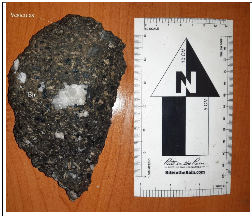
Figura 35. Mineralización de Bornita (Bn) en amígdalas.
