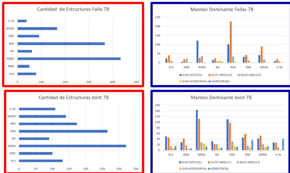
Figura 56: Gráficos de barra sobre la cantidad de estructuras y manteos preferentes de la zona 7B, método 1. (Elaboración propia)
