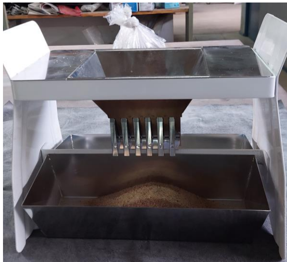
Figura 4.2 Proceso de homogenización con cortador tipo Riffle de la marca Retsch, modelo Riffelteir 6.5
