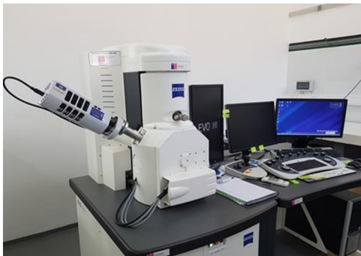
Figura 4.6 Microscopio electrónico de barrido (MEB) Zeiss EVO MA10 con detector EDS Oxford, marca X- MaxN 20 SDN
