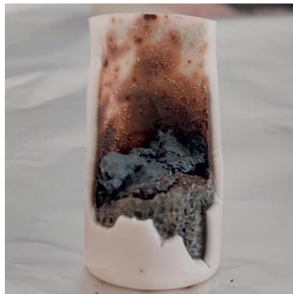
Figura 5.32 Crisol de alúmina roto con el material
